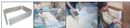
側面材加工 ダブルサンダーで一つ一つ擦り込んでいきます。 細かい調整は熟練の職人によりカンナで仕上げられています。 最後に調整、確認して完成です。
