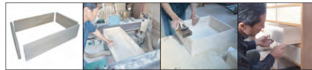
桐箱部品 ダブルサンダーで一つ一つ擦り込んでいきます。 細かい調整は熟練の職人によりカンナで仕上げています。 最後に微調整、確認して完成です。
